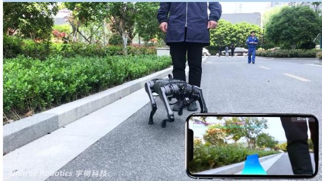
**基于视觉的人体骨架感知和姿态识别:** 针对机器狗视角色彩信息分析计算出人体二维骨架信息, 结合视角场景深度信息, 进一步分析计算出特定人物三维骨架信息及目标人物运动信息, 进而识别人物的特定姿势, 进行人机交互。根据不同人体姿势做出相应的运动, 例如, 起立下蹲、前进后退、扭转等。
