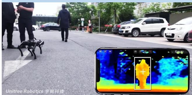
**基于视觉的自主避障:** 针对机器人视角范围 0.8 m 的障碍物进行躲避。可实时检测机器人视角范围内障碍物的分布情况, 调整机身位置。实时显示机器人机身调整角度、视角内最大距离及区域、即将行走轨迹范围。
